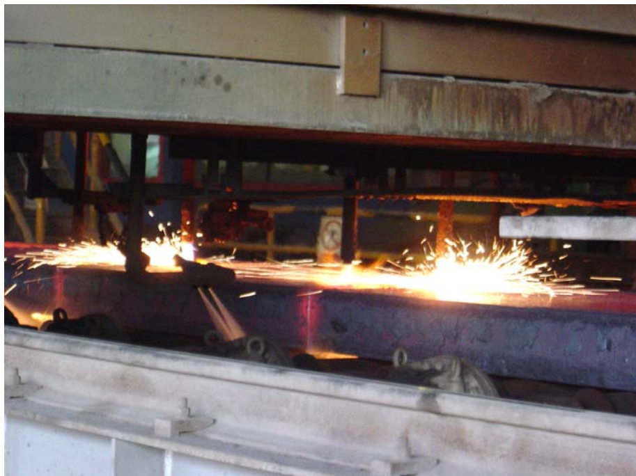
火焰割具在板坯连铸线使用现场
