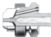
内部混合 (压力装置) 实心锥形喷雾 Full cone-shaped spraying
